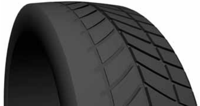
Unsymmetrische Abnutzung des Reifens SP77_37
