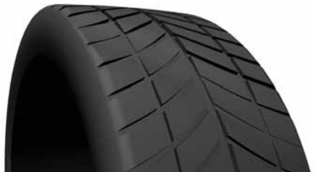
Diagonale Abnutzung des Reifens SP77_38
