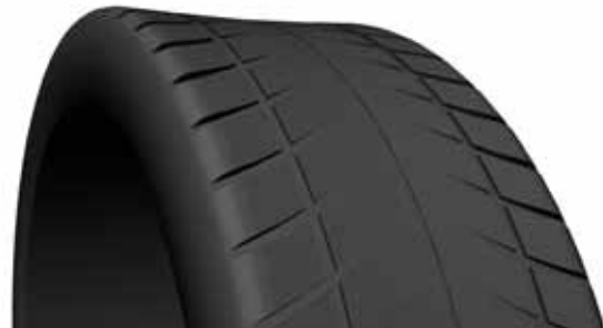
Abnutzung bei Reifenüberdruck
